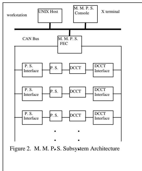
Figure 2. M. M. P. S. Subsystem Architecture
