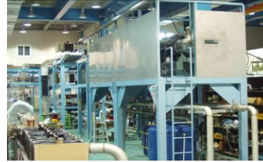
Klystron for DTL 350MHz 1MW CW
